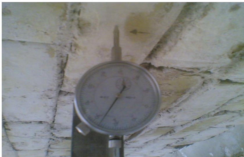
شكل رقم (5) يوضح مقياس الانحراف المستعمل في قياس مقدار الهطول عند منتصف القوس
