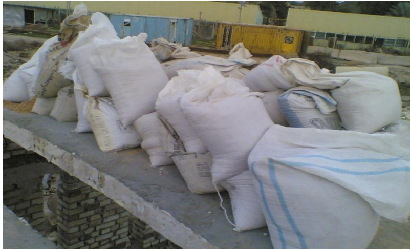
شكل رقم (4) يوضح القوس وهو محمل بوزن 150 كغم /متر من طول القوس
